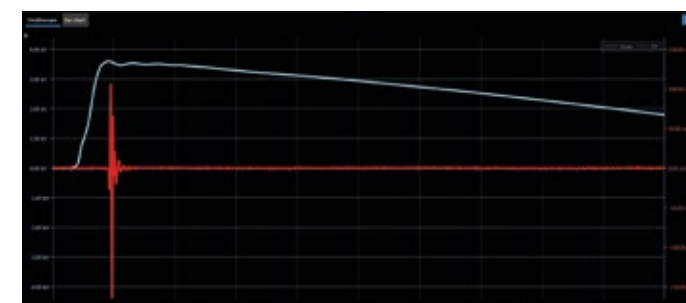
Stoßspannungsimpuls mit 150 ns Anstiegszeit und TE-Effekten
