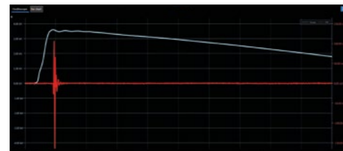
Stoßspannungsimpuls mit 150 ns Anstiegszeit und TE-Effekten
