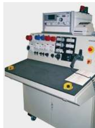
Prüfanlage zum Testen von Verlängerungskabeln
