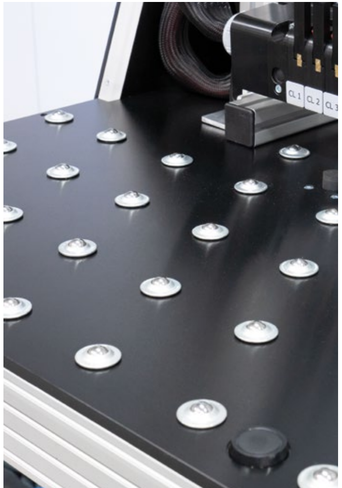
In die Arbeitsfläche integrierte Rollkugeln zur einfachen Positionierung von Prüfobjektträgern.
