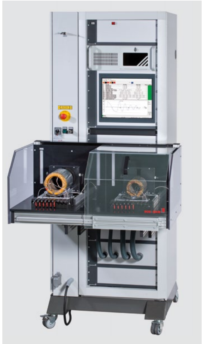
Prüfhaube direkt an ein Prüfsystem am 19"-Schrank montiert.
