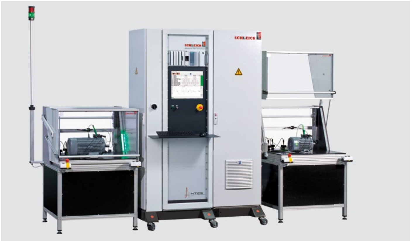
Doppelstation mit wechselseitigem Prüfen in zwei Einzelprüfhauben.
