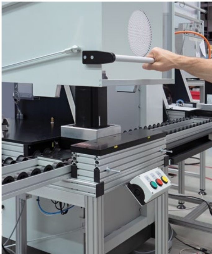
Prüfhaube mit einem durchlaufenden manuellen Rollenband.
