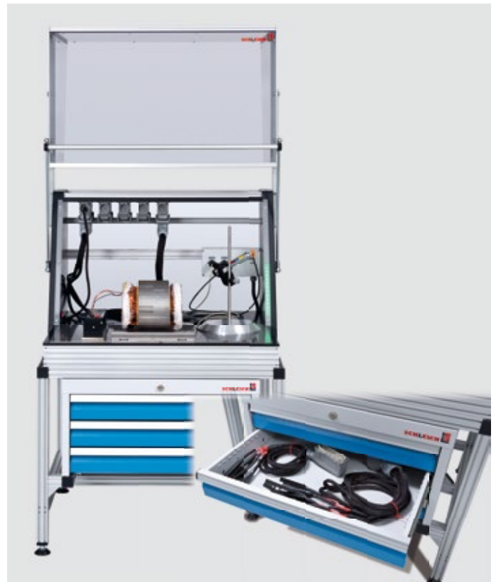
Prüfhaube montiert auf einem Tischargestell und zusätzlich integrierten Schubladenauszügen für Prüfadapter, Prüflösungen etc.
