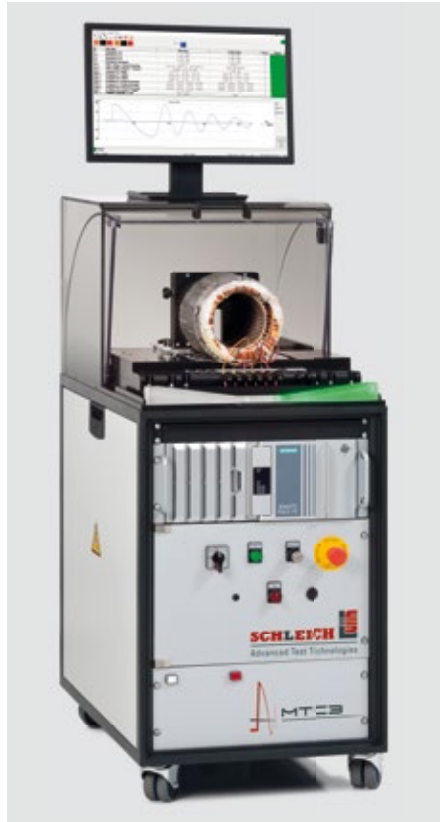
Prüfhaube direkt auf ein Prüfsystem im Rollcontainer montiert.
