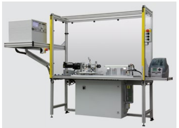
Motorprüfsystem mit Prüfkabine mit drei geschlossenen Seiten.
