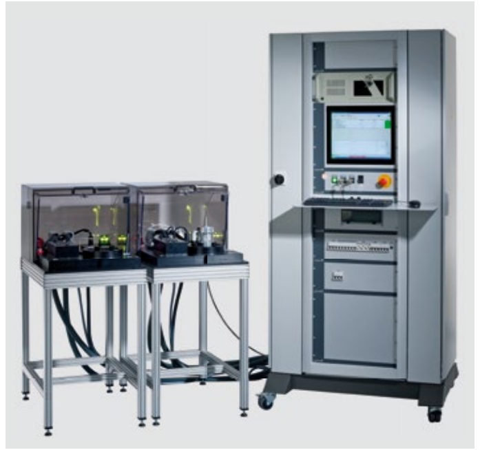
Doppelprüfstation bestehend aus zwei einzelnen Prüfhauben.
