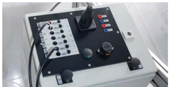
Kombination aus pneumatischen Klemmen mit Steckdose und Starttasten in einer Bedieneinheit
